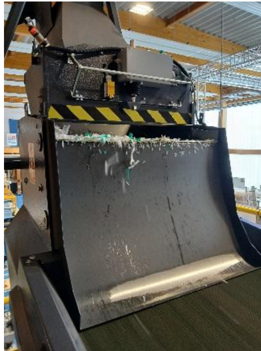
Sortiervorgang - Rutsche - Trennzone – Zuführungsband; NIR-Sortieranlage
