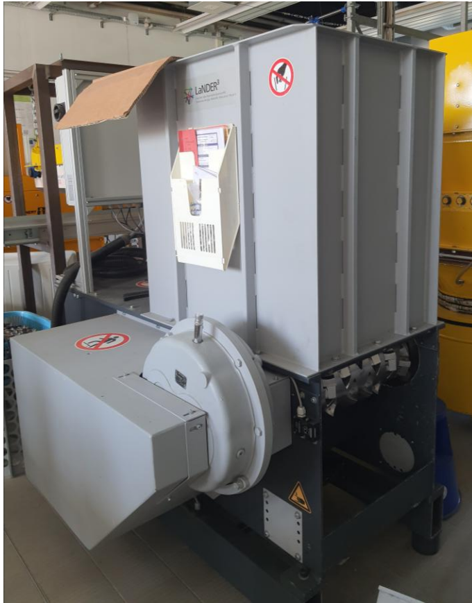
Zerkleinerung für die Sortierung im Einwellenzerkleinerer
